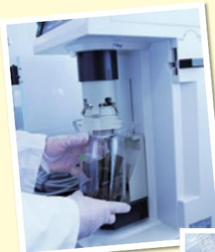
▲検査する食品をセラミック刃の専用ミキサーで粉碎し、12時間以上かけて乾燥させて検査します。
