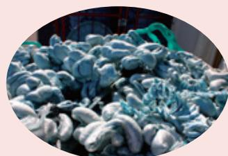
発泡スチロールを溶かして固形化する作業
